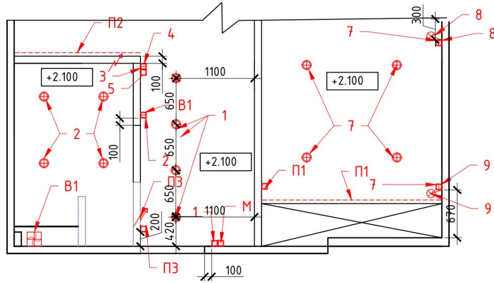
План потолка с расстановкой светильников на отмпетке +3,600 M1:50
