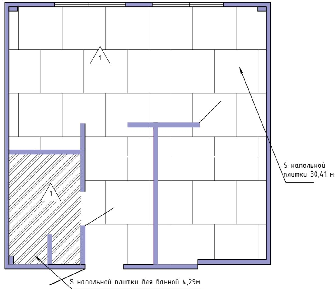
План пола на отм. +2.192 М1:50
